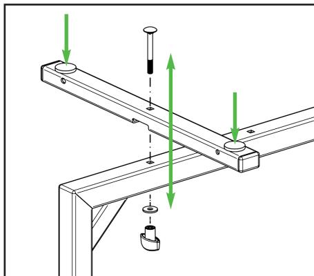
Für die Montage der Tischplatte müssen die Auflagerohre auf das U-Gestell geschraubt werden. Hierzu das Auflagerohr mit der Aussparung nach unten auf das U-Gestell ablegen. Die Schlossschraube von oben durch das Auflagerohr und das U-Gestell stecken. Die Schlossschraube von unten mit der U-Scheibe und der Klemmmutter verschrauben. Klemmmutter handfest anziehen. Den Vorgang mit dem zweiten Auflagerohr wiederholen. Jeweils zwei Filzauflagen auf die Oberseite des Auflagerohres kleben.
