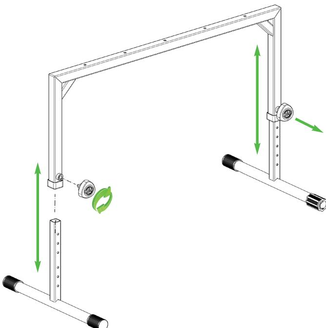
Die Rast-Klemmschrauben ca. fünf Umdrehungen in den U-Rahmen einschrauben. Fußgestell in U-Rahmen schieben. Darauf achten, dass die Bohrungen des Fußgestelles in Richtung der Rast-Klemmschraube zeigen. Durch festziehen der Rast-Klemmschrauben wird das Fußgestell in der Höhe fixieren.
