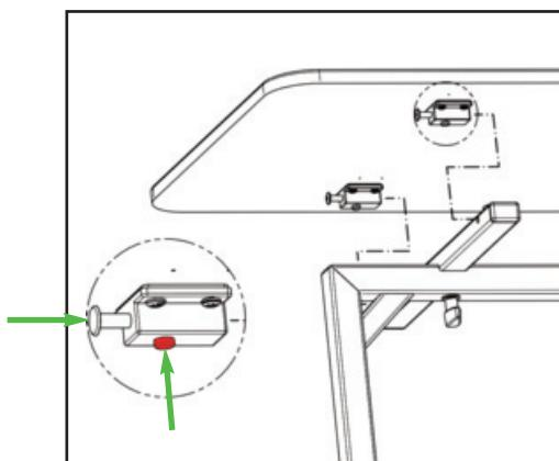
Zum Auflegen der Tischplatte müssen die vier Schnellspanner „geöffnet“ werden. Hierzu den roten Knopf auf dem Schnellspanner drücken. Der Verriegelungsstift schnappt nach hinten und die Tischplatte kann montiert bzw. demontiert werden.
